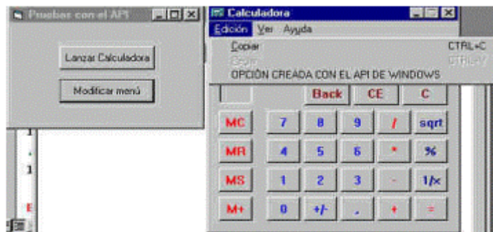
Figura 487. Opción de menú agregada a la aplicación Calculadora mediante el API de Windows.
